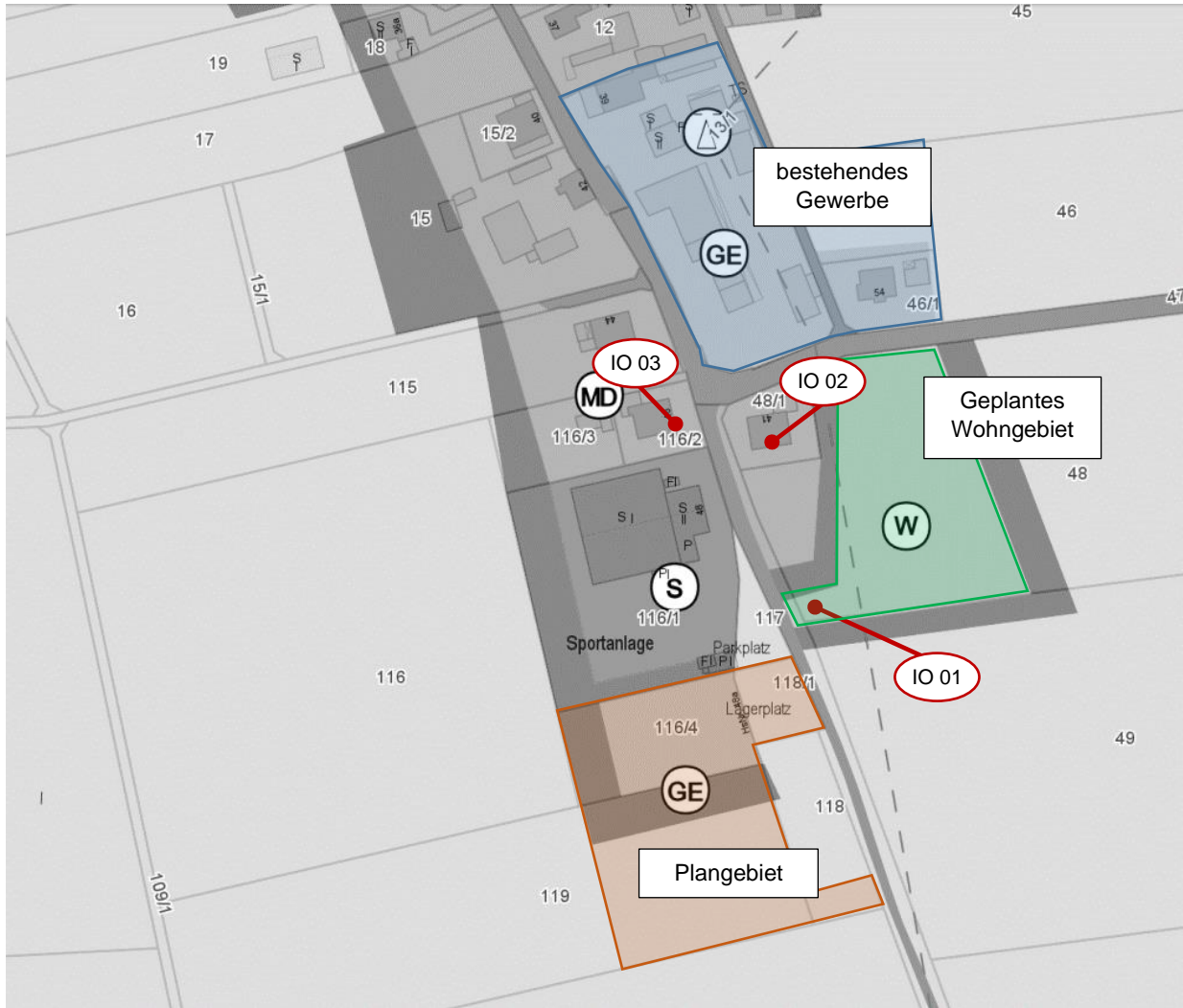
Auszug Flächennutzungsplan Neuzell mit Darstellung des Plangebietes sowie der untersuchten Immissionsorte ( IO )
